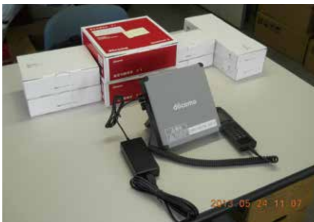
▲配備した衛星電話機
