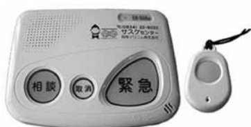
緊急通報機器
