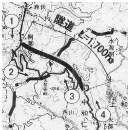
白木・和水町間のトンネル
