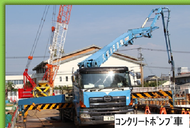
コンクリートポンプ車
