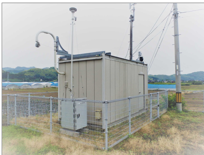
立花総合保健福祉センターかがやき敷地内にある一般環境大気測定局
